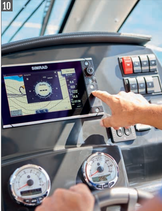
Integrierter Steuerstand mit SmartCraft-Instrumentierung, Einbaubereich für 9" GPS/Chartplotter
