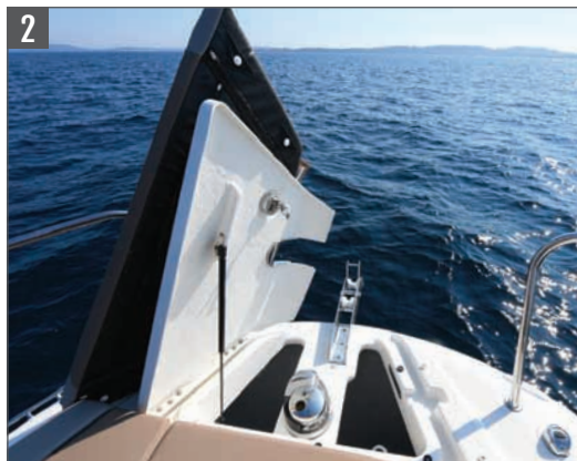
2 Ankerkasten und Ein-/Ausstiegsbereich über den Bug
