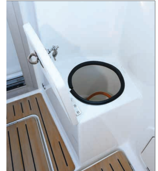
Stauraum für LPG-Tank
